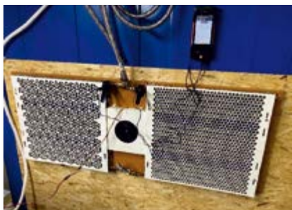
Rys. 3. Jeden z pierwszych prototypów indukcyjnego panelu klimatyzacyjnego iPANEL-I podczas testów wydajnościowych wymienników ciepła. Wersja z funkcją wentylacji i odzyskiem ciepła to ten sam ultracienki panel na ścianie pomieszczenia. Brak kanałów powietrznych w pomieszczeniu, pełne chłodzenie i ogrzewanie
