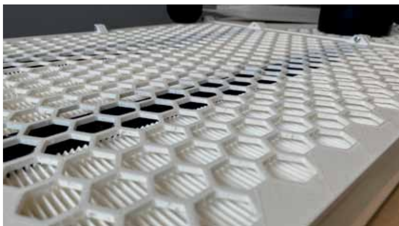
Indukcyjny panel klimatyzacyjny w czasie przeprowadzania testów przepływowych i akustycznych
