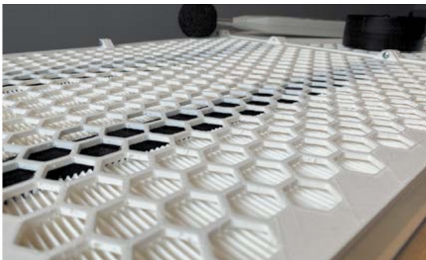
Rys. 2. Prototyp indukcyjnego panelu klimatyzacyjnego iPANEL-I (wydruk 3D) podczas pomiarów przepływowych i akustycznych
